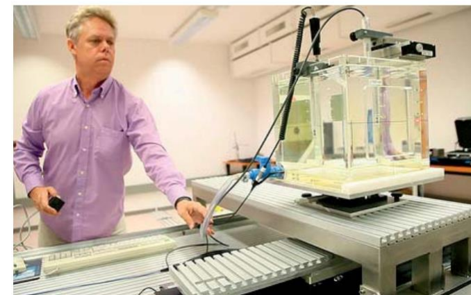
Наладка оборудования для калибровки дозиметрии в Дозиметрической лаборатории МАГАТЭ.
