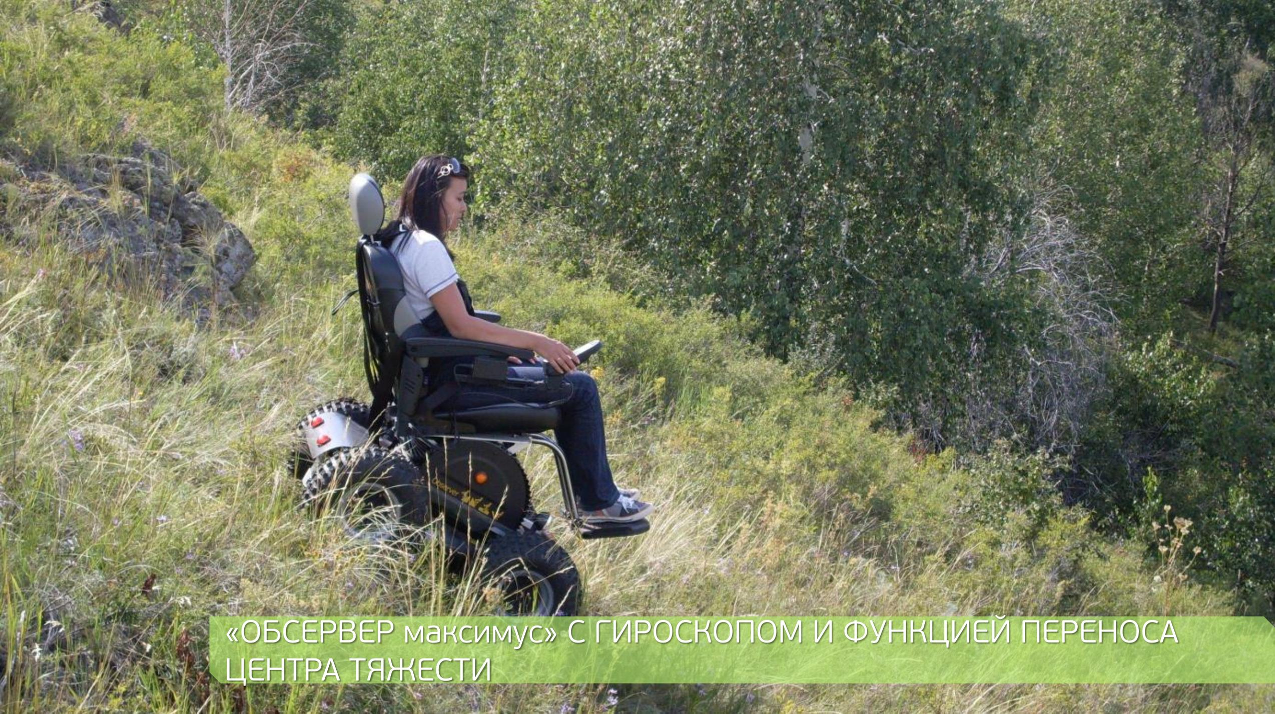
«ОБСЕРВЕР максимум» С ГИРОСКОПОМ И ФУНКЦИЕЙ ПЕРЕНОСА ЦЕНТРА ТЯЖЕСТИ
